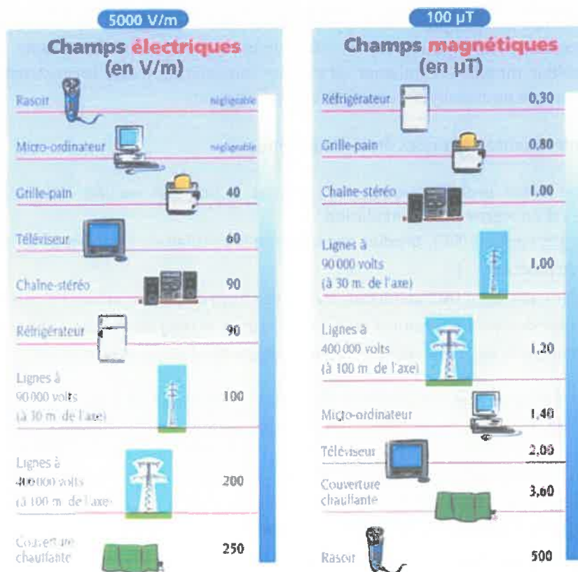
Figure 1 : Comparaison entre champ électrique(V/m) et champ magnétique (µT) 2
